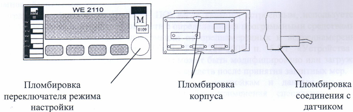
Рисунок 5 — Схема пломбировки с помощью разрушаемых наклеек прибора весоизмерительного WE2110
