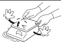
Не располагать весы вблизи высоковольтных кабелей, радиопередатчиков и других источников электромагнитных помех.
