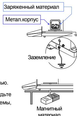
используйте подвес (в нижней части весов), чтобы подвесить материал подальше от воздействия магнита.
