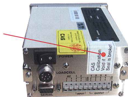
Рисунок 3 — Общий вид и место пломбировки индикаторов CI
