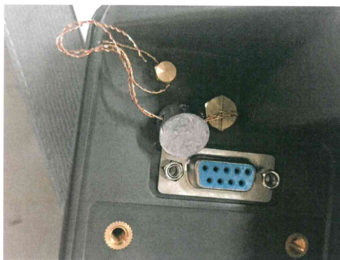
Рисунок 2 - Место пломбировки весов
